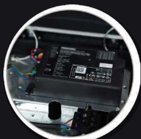
驱动器舱 — 可拆卸接线板
