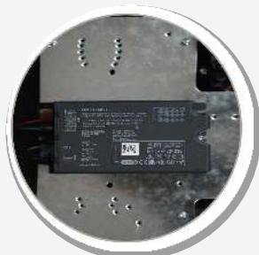
DALI-2 / D4i 驱动器, 断电 NFC 编程
