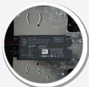
Driver DALI-2 / D4i, NFC senza tensione
