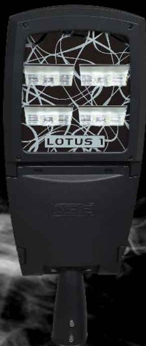
LOTUS 1 abierto — módulo LED LUSO 7070, driver extraíble y base Zhaga Book 18 · 20
