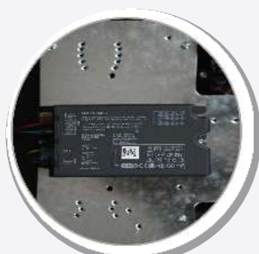
Driver DALI-2 / D4i, NFC sin tensión
