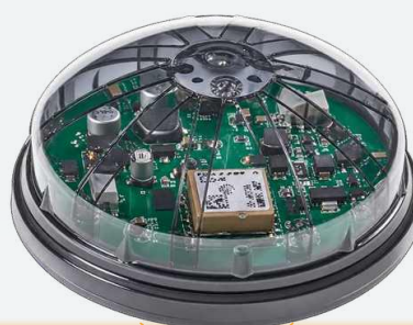
Nodo LiDAR D-SLS su presa Zhaga Book 18 · 20 — D4i, innestabile in qualsiasi momento senza aprire la colonna
